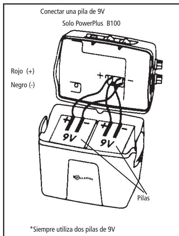
\*Siempre utiliza dos pilas de 9V
