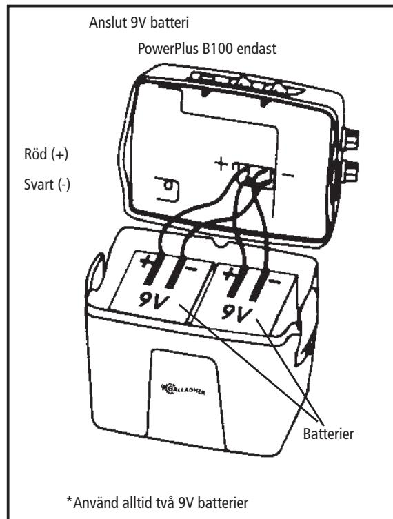
OBS! Koppla alltid ifrån batteriet (batterierna) när de inte används.
