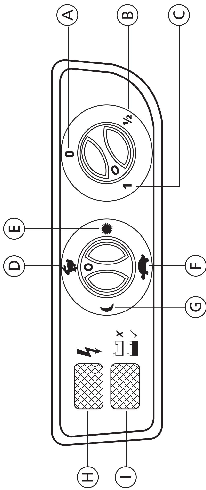
Für eine optimale Batterienutzung stellen Sie das Elektrozaungerät auf 'halbe Leistung' ein **(B)**. Wenn das rote Zaunanzeigelämpchen **(H)** nicht aufleuchtet, schalten Sie das Gerät auf 'volle Leistung', **(C)** um genügend Spannung auf der Zaunleitung zu bekommen.
